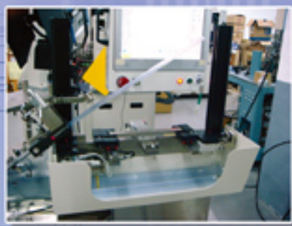
入料 (料管/Tray盤) Tube/Tray Feeder
